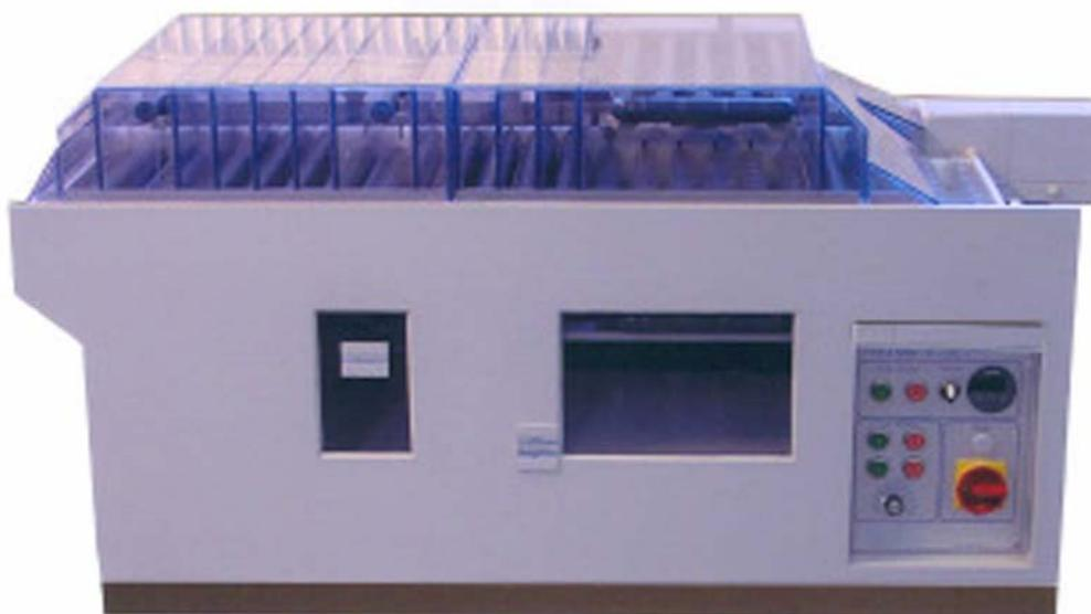
Die Durchlaufätzmaschine SPRINT ist zur Fertigung von doppelseitigen Klischees mit besonders feinen Strukturen konzipiert.
